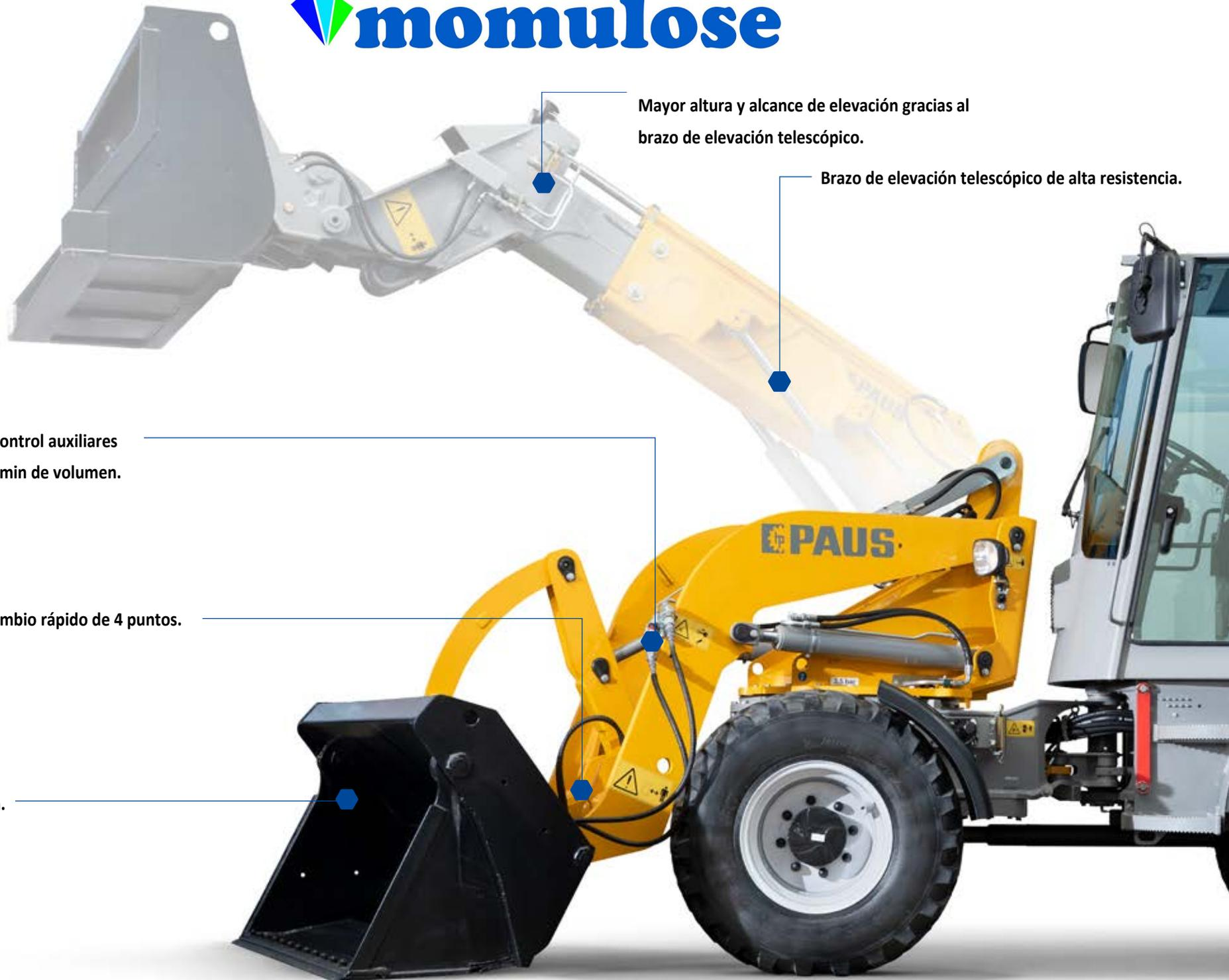
Mayor altura y alcance de elevación gracias al brazo de elevación telescópico.
